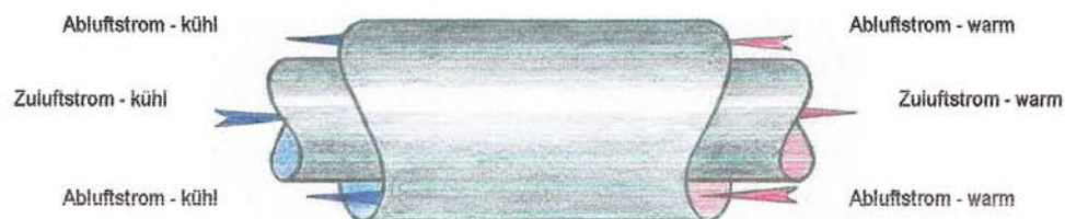
®ISOMAX – koaxiale Rohr – in – Rohr - Gegenstromanlage Material: Edelstahl / flexibles Endloswickelrohr
