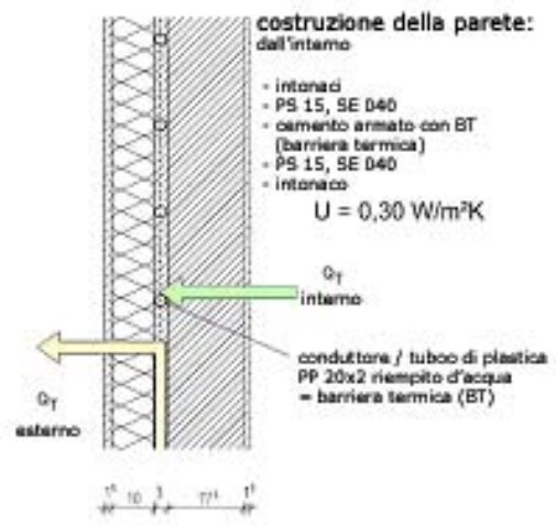
fig. 4.3. parete esterna in muratura con BT
