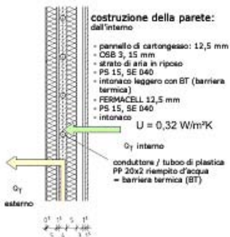
fig. 4.4. parete esterna di una casa di legno con BT
